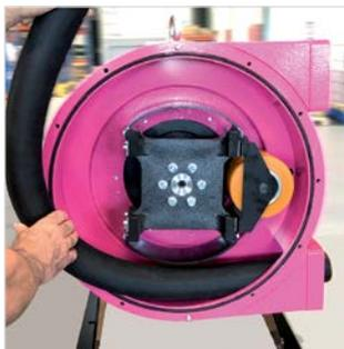
6. Disporre gli anelli di pressione. Fra l'estremità del tubo e l'anello di pressione deve rimanere una distanza precisa (vedere fig. 1 e 2).
